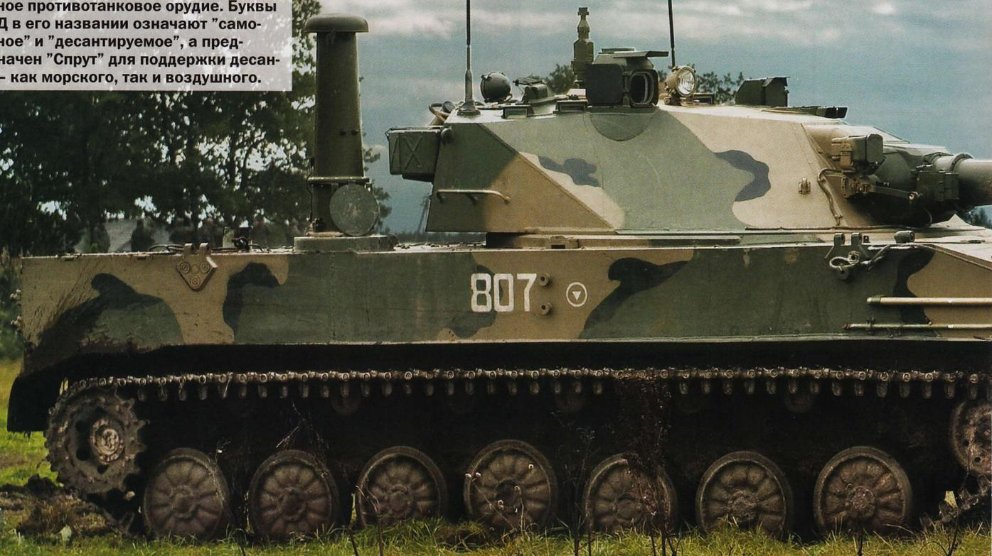
Корни или, если хотите, щупальца "Спрута-СД", который сейчас некоторые называют "новейшей разработкой", растут еще из 70-х годов, из опытного легкого танка "Объект 934". К 90-м годам на его базе и на базе БМД-3 сделали противотанковую самоходную пушку 2С25, добавив к шасси два дополнительных катка и установив на него мощную 125-мм пушку, которой вооружены наши основные танки Т-72, Т-80 и
