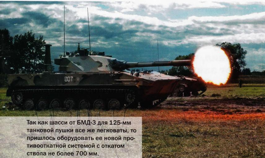
Так как шасси от БМД-3 для 125-мм танковой пушки все же легковаты, то пришлось оборудовать ее новой противооткатной системой с откатом ствола не более 700 мм.
