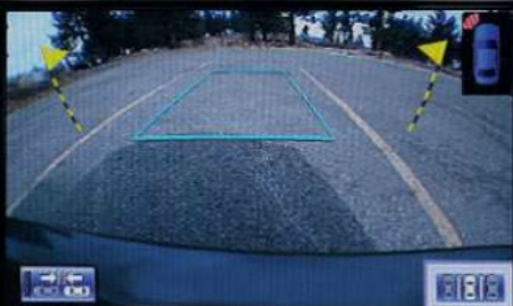
Камера заднего вида с динамической разметкой
