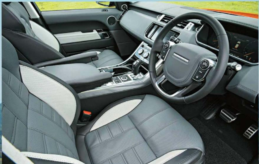
В отделке салона Range Rover Sport имеет много общего с Range Rover. Интерьер может быть и сдержанно строгим, и разнузданно кричащим – хоть с красными кожаными сиденьями и белым замшевым потолком. Но качество материалов и сборки всегда на высоте. Вместо циферблатов спидометра и тахометра на дорогих версиях – единый дисплей. А вот селектор 8-ступенчатого автомата в форме шайбы, как на седанах Jaguar, здесь заменен джойстиком от родстера Jaguar F-type
