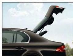
Две кнопки для открытия багажника в разных режимах.
