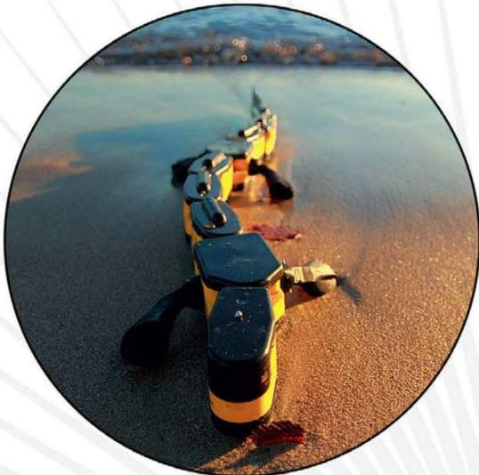
Робот под названием Salamandra Robotica 2 в отличие от других обладает не одним умением. Устройство умеет ходить, бегать, ползать, плавать и даже карабкаться по деревьям и трубам. Причудливый робот похож на огромную ящерицу, а его создатели уверяют: Salamandra можно использовать в том числе во время стихийных бедствий – например, для проникновения в труднодоступные участки.
