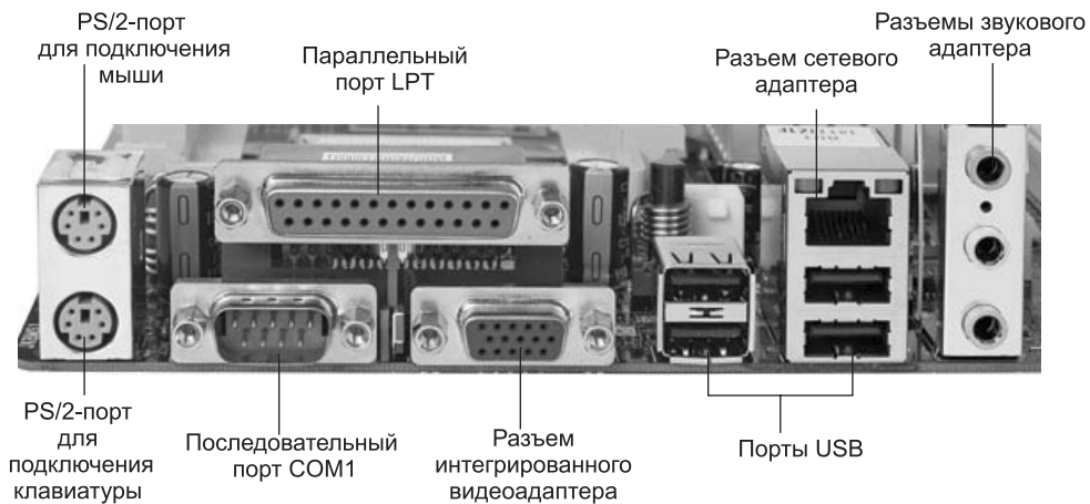
Рис. 1.5. Разъемы на задней панели системной платы
