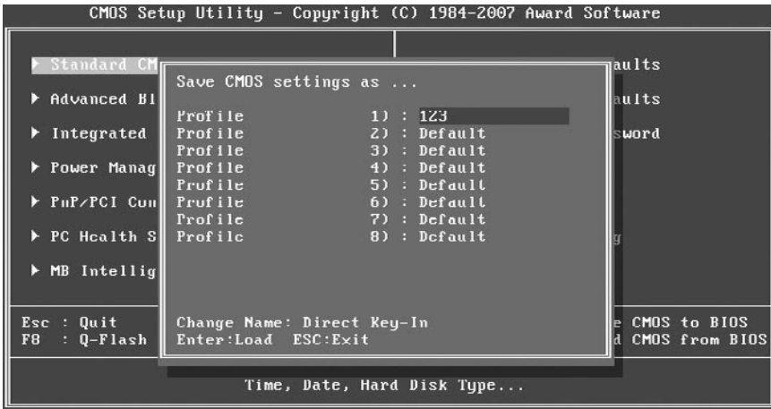
Рис. 2.13. Сохранение профиля BIOS в платах Gigabyte
