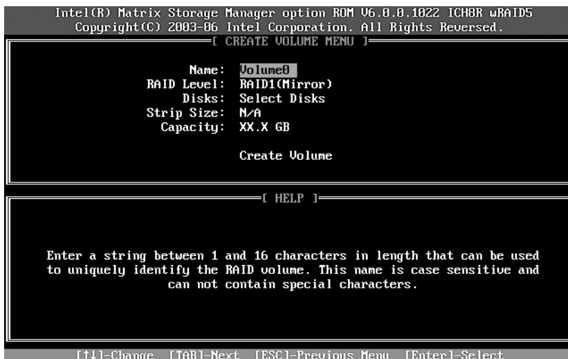
Рис. 6.11. Создание нового массива в программе Intel Matrix Storage Manager option ROM
