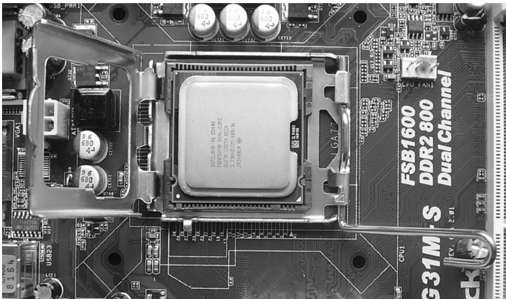
Рис. 6.4. Новый процессор установлен в разъем LGA 775
