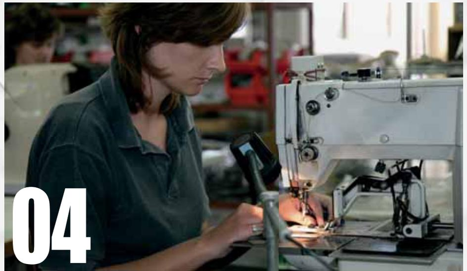
01 LOWA verwendet ausschließlich hochwertiges Rindleder europäischer Herkunft 02 Echte Handarbeit ist bei der Fertigung eines LOWA-Schuhs unabdingbar 03 Überflüssiges Sohlenmaterial wird fachfräulich entfernt 04 Die Einzelteile werden von ausgebildeten Näherinnen und Nähern zu einem LOWA-Schuh verarbeitet
