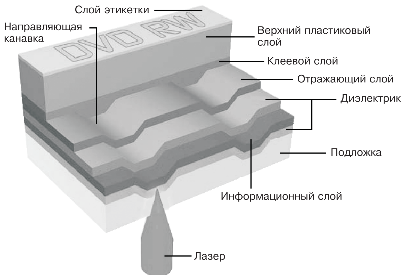
Рис. 3.1. Структура перезаписываемого DVD-диска
