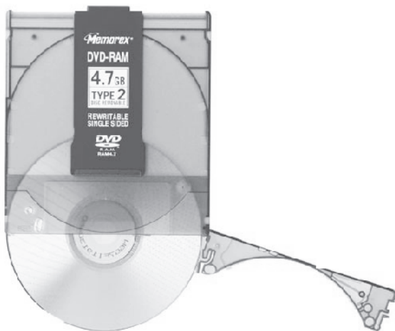
Рис. 3.3. Диск DVD-RAM размещен в картридже
