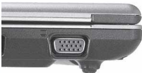
Рис. 15.1. Разъем D-Sub на боковой панели ноутбука
