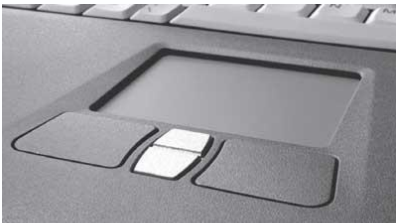
Рис. 4.9. Наиболее часто в ноутбуках используются сенсорные панели – Touchpad, иногда производители добавляют к ним дополнительные кнопки
