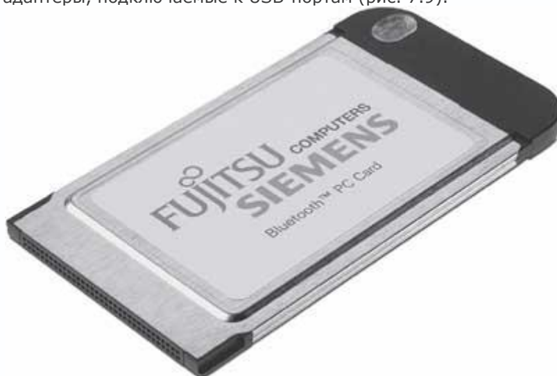
Рис. 7.9. Bluetooth-адаптеры на базе PC-карт встречаются нечасто, но для пользователей ноутбуков удобнее именно они, а не подключаемые к USB-портам
