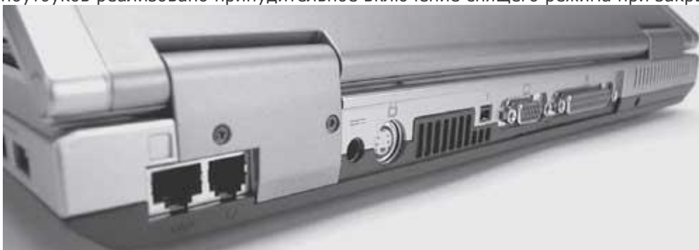
Рис. 10.1. Перегрев внутренних устройств ноутбука можно вызвать, случайно закрыв вентиляционные решетки ноутбука
