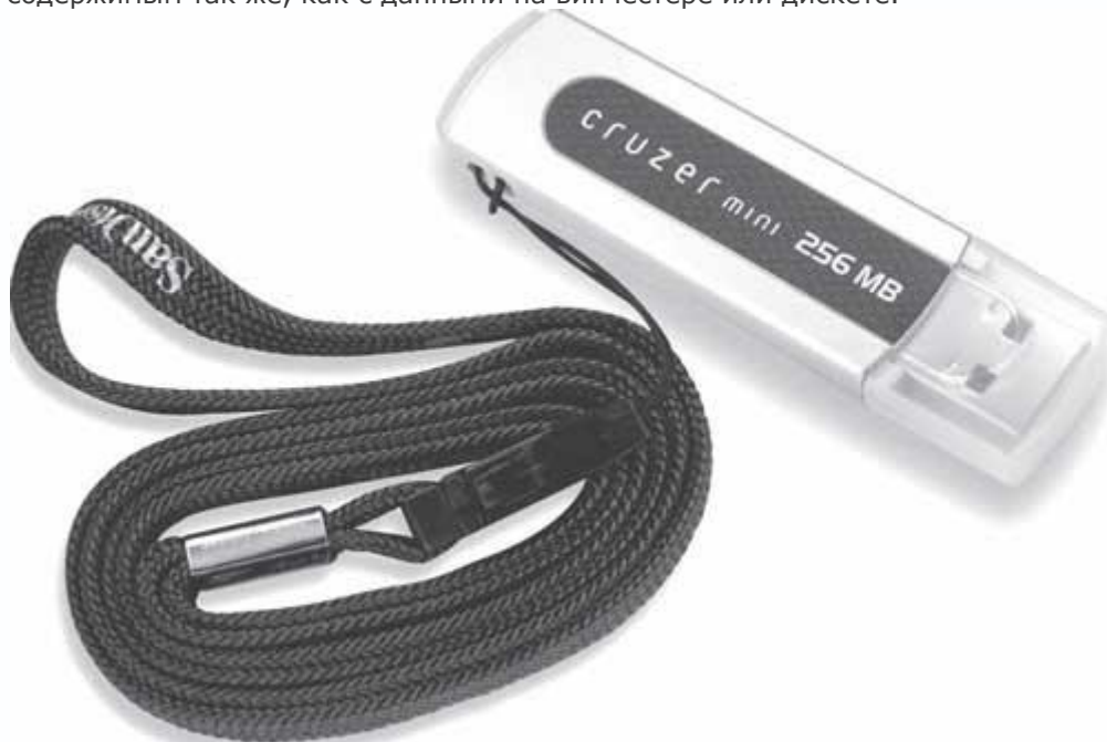
Рис. 7.11. Flash-устройства – самый удобный способ переноса информации между компьютерами
