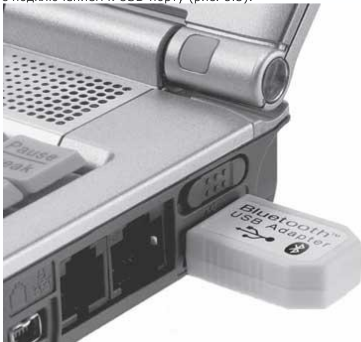
Рис. 8.3. Модули беспроводных интерфейсов можно подключить к внешним портам ноутбука
