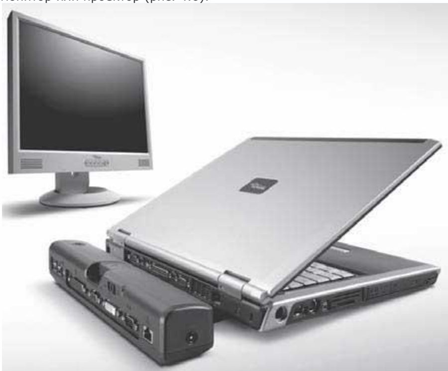
Рис. 4.6. Некоторые ноутбуки (обычно модели, рассчитанные на профессиональное применение) позволяют подключать сразу два внешних монитора
