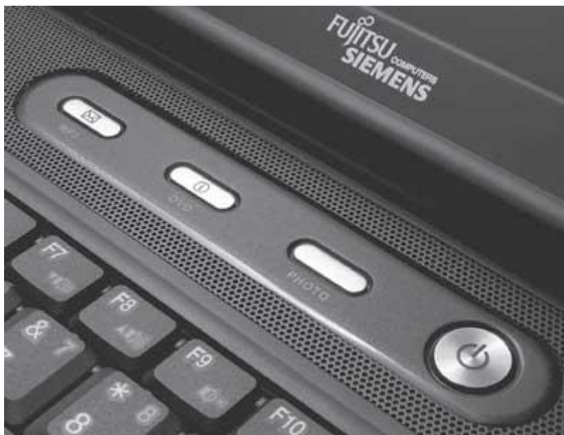
Рис. 4.8. На клавиатуре ноутбука обычно присутствуют дополнительные клавиши, которые можно настроить на запуск наиболее часто используемых приложений
