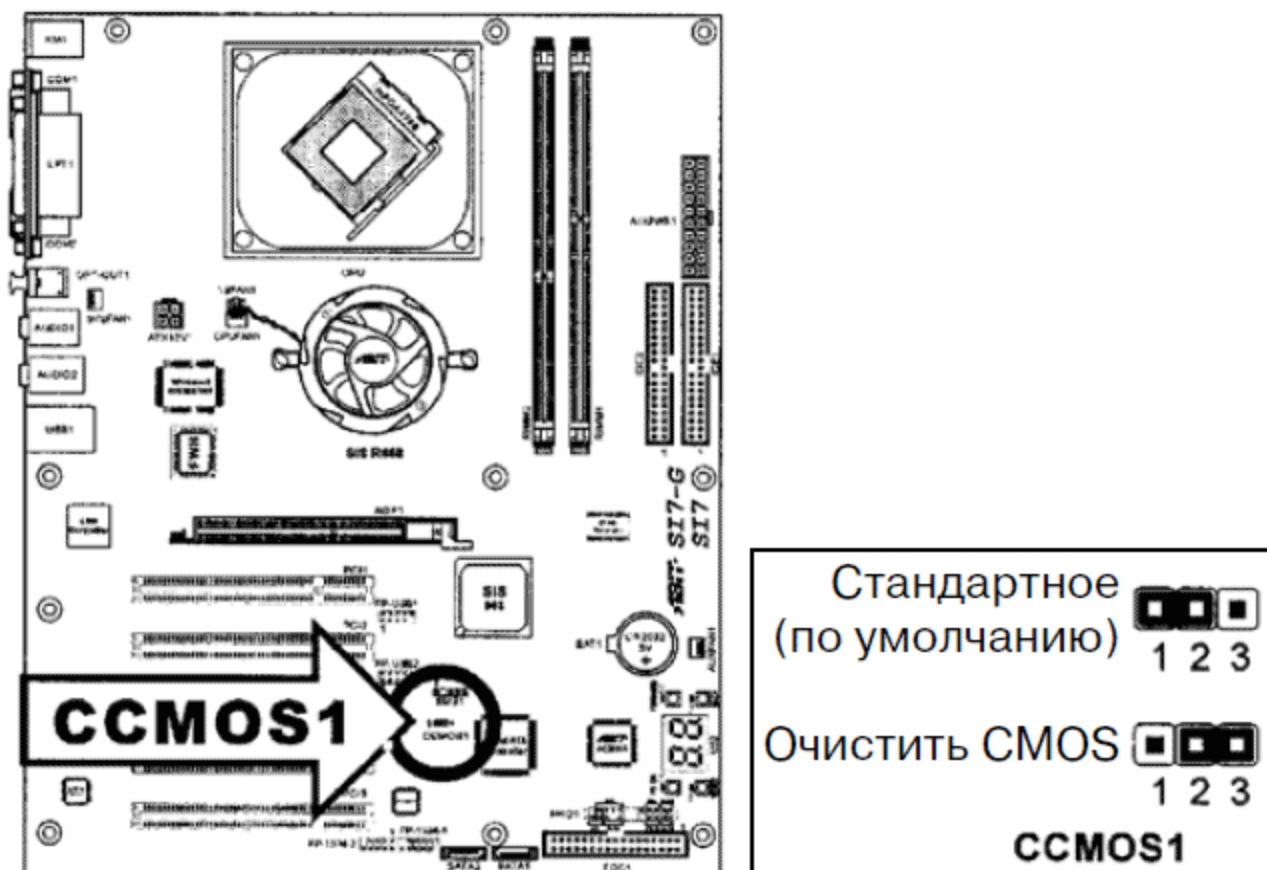
Рис. 2.1. Положение джампера разрядки CMOS, материнская плата ABIT S17 (собственность компании ABIT Computer Corporation; используется с разрешения)
