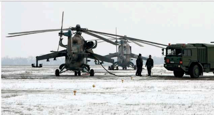
TANKOLÁS: Fogyasztása 900 liter/óra, hatótávolsága a szárnyra szerelhető póttartályokkal közel duplájára növelhető
