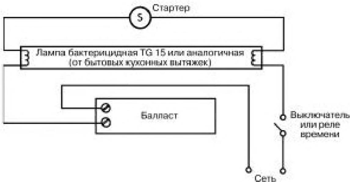
Рис. 2.12. Принципиальная электрическая схема стирального устройства для СППЗУ
