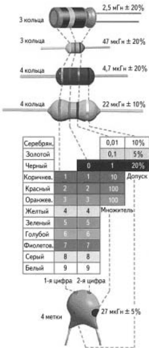
Рис. 42. Цветовая маркировка индуктивностей
