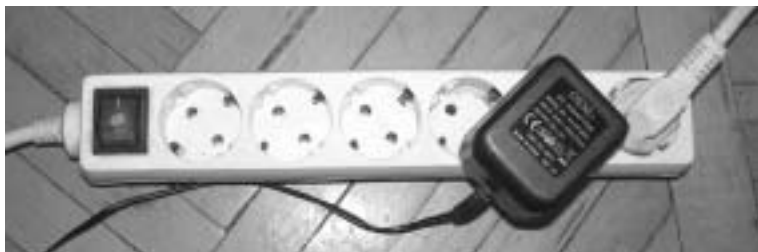
Рис. 7. Промышленный сетевой фильтр по питанию (ФП) Pilot
