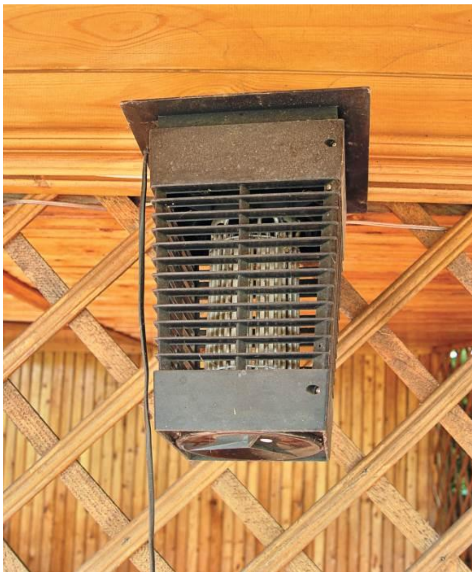
Уличный светильник с защитой от комаров
