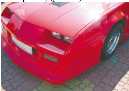
Рис. 1.8. Установка аэродинамического обвеса во многих случаях снижает дорожный просвет
