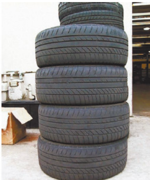
Рис. 4.12. Хранение покрышек стопкой приводит к их деформации (так можно хранить только короткое время)
