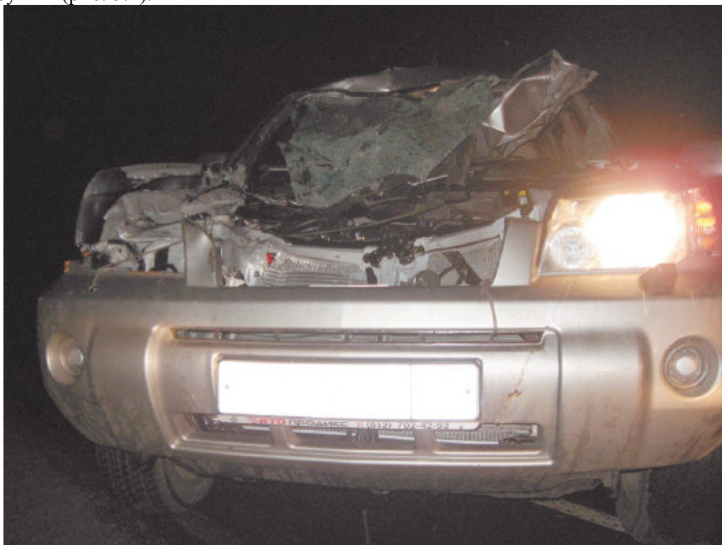
Рис. 5.1. Если произошло ДТП, не забудьте отключить электрооборудование – в разбитом автомобиле возможны короткое замыкание и пожар
