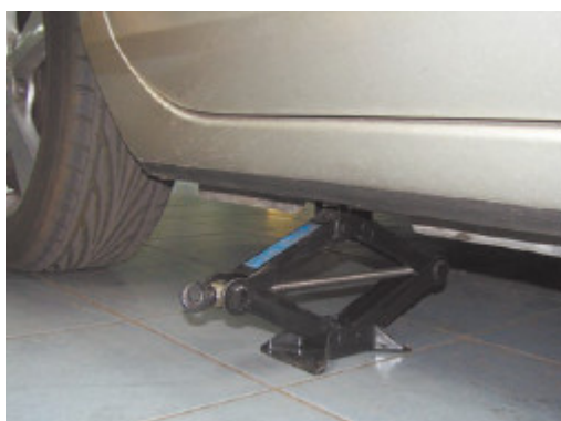
Рис. 4.4. Подпор машины домкратом
