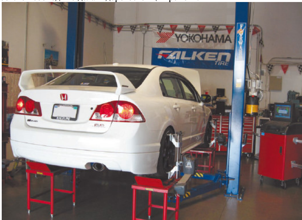
Рис. 1.12. Регулировка развала и схождения колес на СТО
