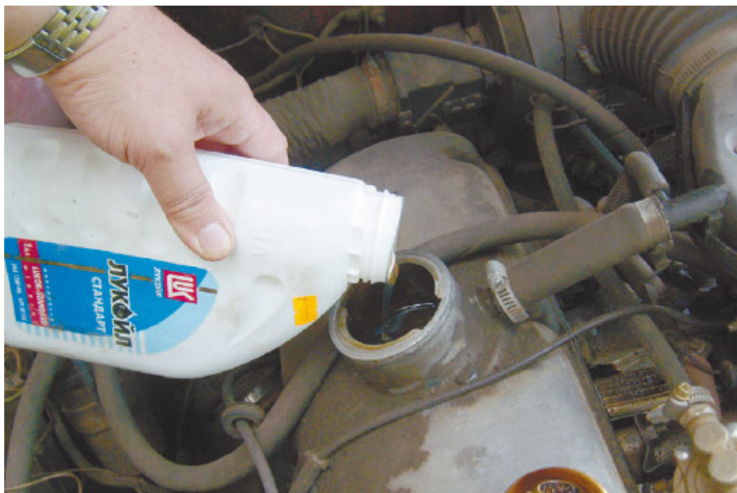
Рис. 1.31. Так образуются потеки масла у горловины для заливки, при этом двигатель в абсолютном порядке
