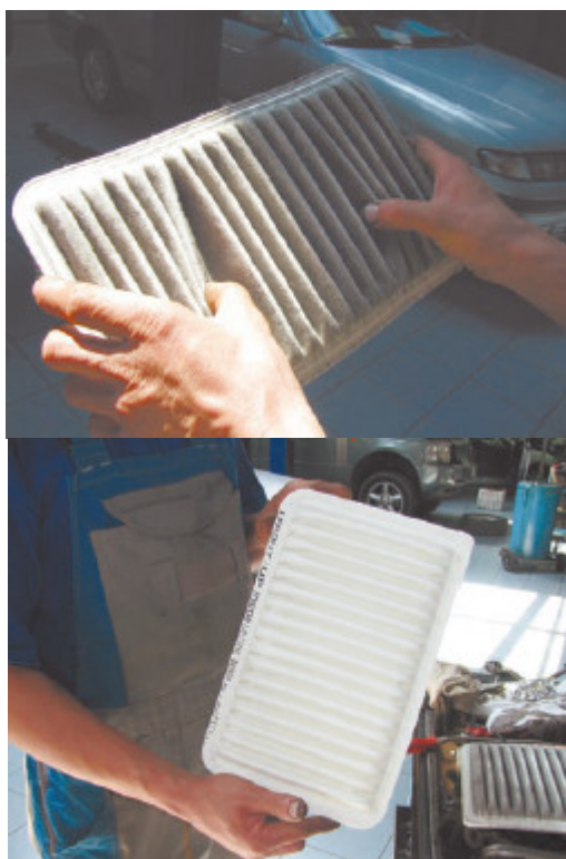
Рис. 3.3. Старый и новый воздушный фильтр
