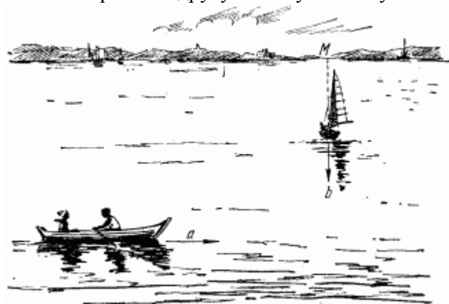
Рис. 11. Парусная лодка идет наперерез весельной. Стрелки a и b – скорости. Что увидят гребцы?
